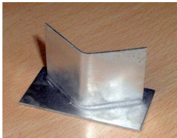
Nella foto è possibile vedere un'unione di due lamierini di 1 mm di spessore realizzate con MALLOY 56.
